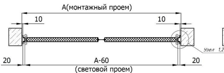
Рисунок 11. Разрез А-А. МДД Тр с плоским отбойником
