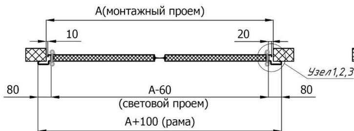
Рисунок 4. Разрез А-А. МДД Тр с плоским отбойником
